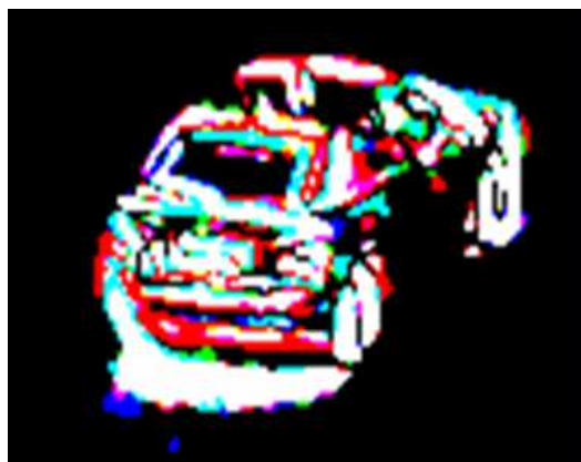
(b) Odstranění šumu pomocí rozmazání a nízkou hladinou prahu.
