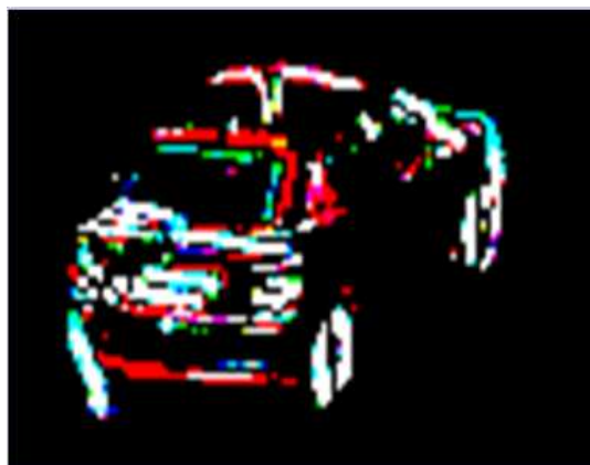
(a) Odstranění šumu vysokou hladinou prahu – detail.
